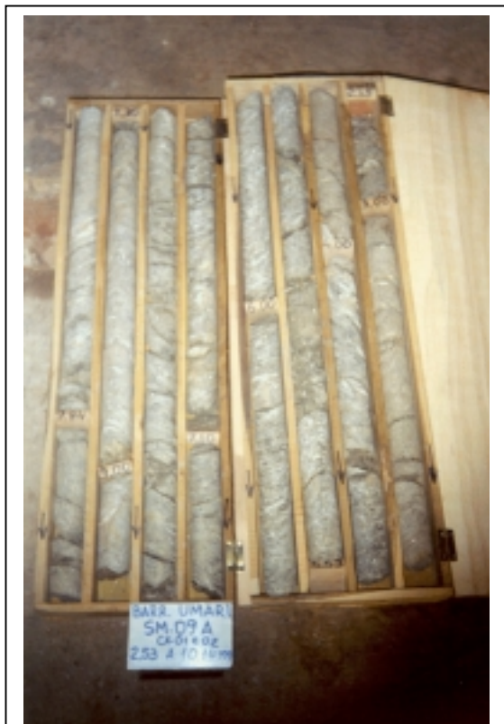
FOTO 08 - SM-09-CAIXA-01 e 02 TRECHO:2,53m a 10,14m
